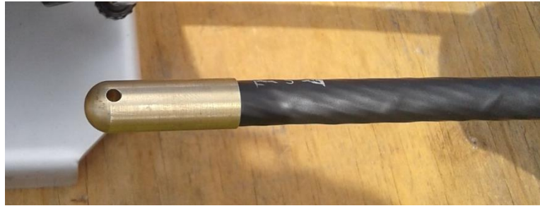
FOTO 1: Ponta do cabo preparada
