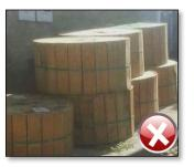
Proibido transportar e armazenar a bobina na posição horizontal (deitada) e/ou apoiadas pelas ripas.
